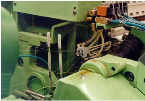
Fig. 6: Air-jet loom
